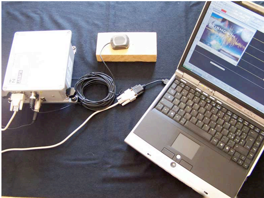
Fig. 1: collegamento della stazione al computer *
